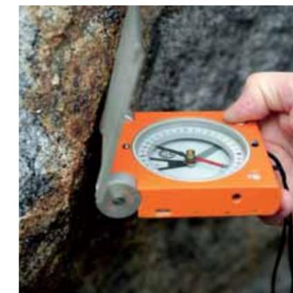
Mit dem Geologenkompass wird das „Streichen“ und das „Fallen“ und damit die Lage des Gesteins im Gelände vermessen.
