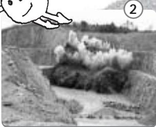
Durch Sprengung wird das massive und harte Gestein aus der Felswand gelöst.
